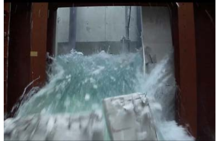
水圧で外壁材を破壊させる水理実験
