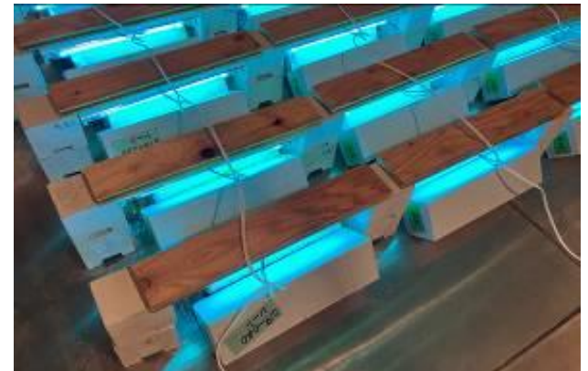
仕上塗材のばくろ試験（左：実環境，右：促進環境）
