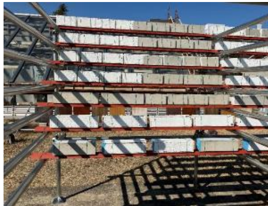
仕上塗材のばくろ試験（左：実環境，右：促進環境）
