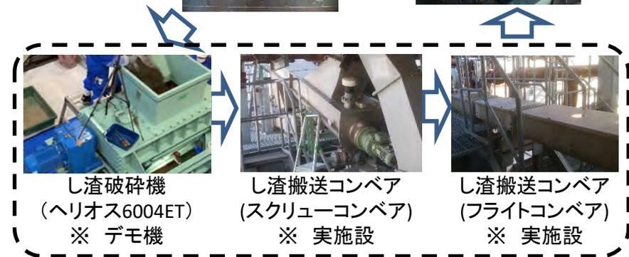
図 想定するバイオマス搬送フローとR2年度の検討範囲(破線部)
