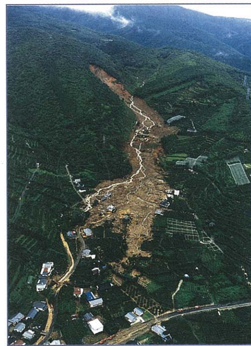
図-1 斜面崩壊の流動化による土砂災害(1997.7鹿児島県出水市針原川:国際航空写真(株))
